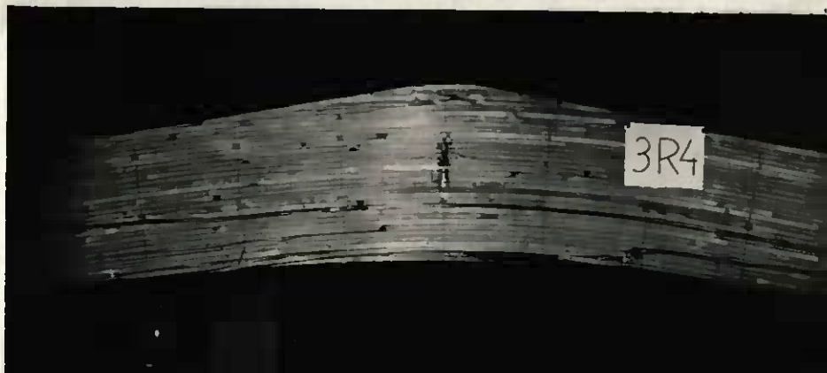
Bild 23: Typischer Querzugbruch bei Bauart 2
