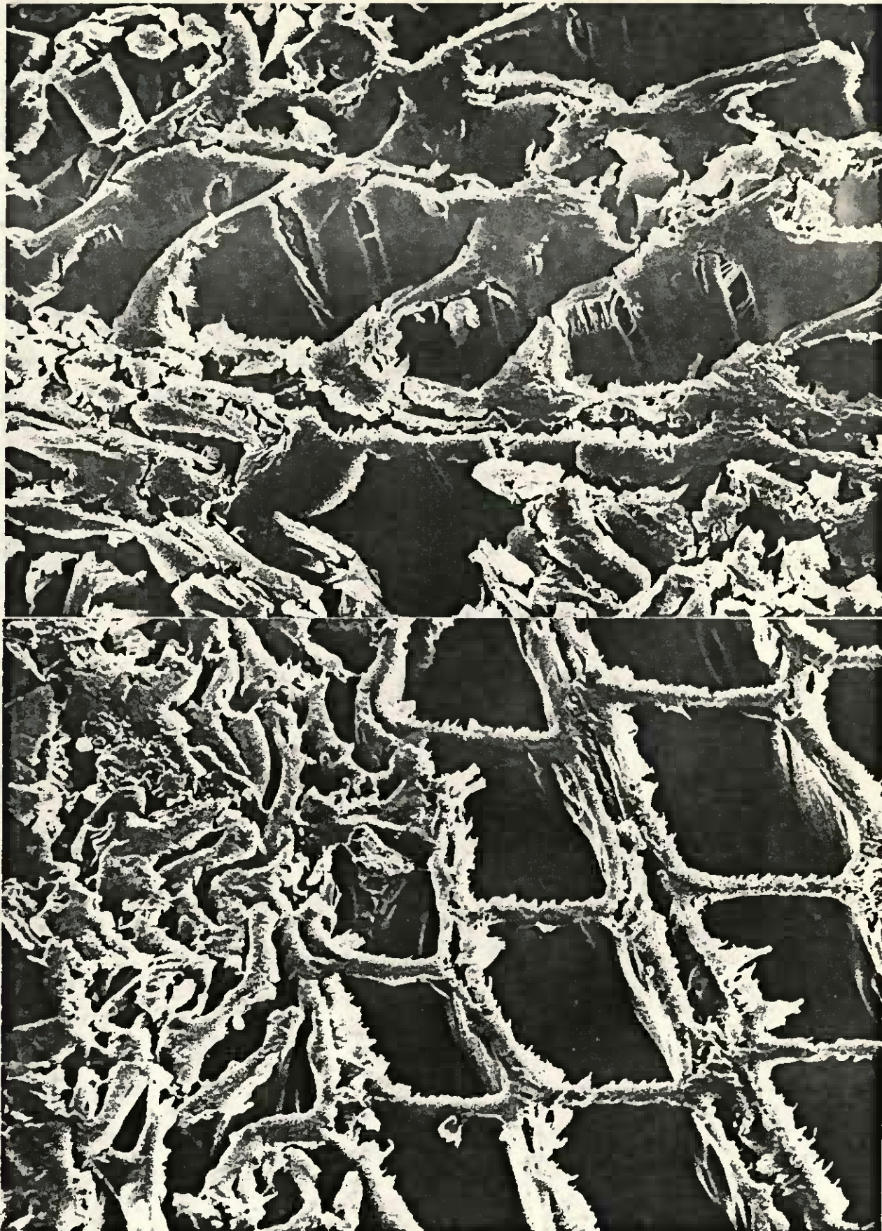
Abb.15 Fichtenholz, während der Chlor-Behandlung belastet, Druckbereich, rasterelektronenmikroskopische Aufnahmen; 10 % Chlor, 1500-fach (oben), 30 % Chlor, 1000-fach (unten)
