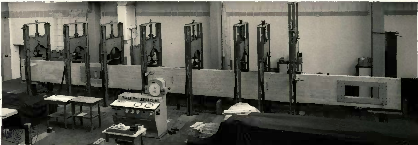
Abb. 4 Träger VI während des Versuchs in der Biegeprüfmaschine.
