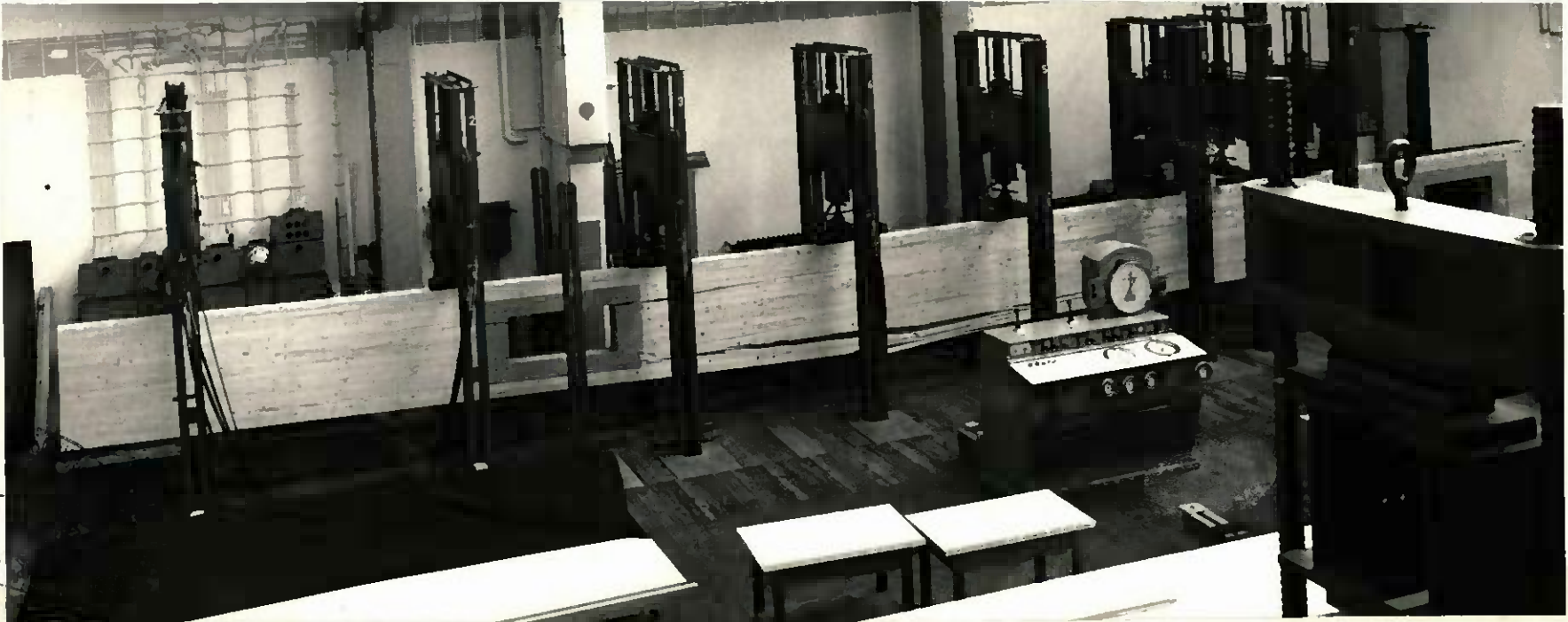
Abb. 11 Träger V nach dem Versuch in der Biegeprüfmaschine. Erreichte Höchstlast \max F = 359 \text{ kN} .
