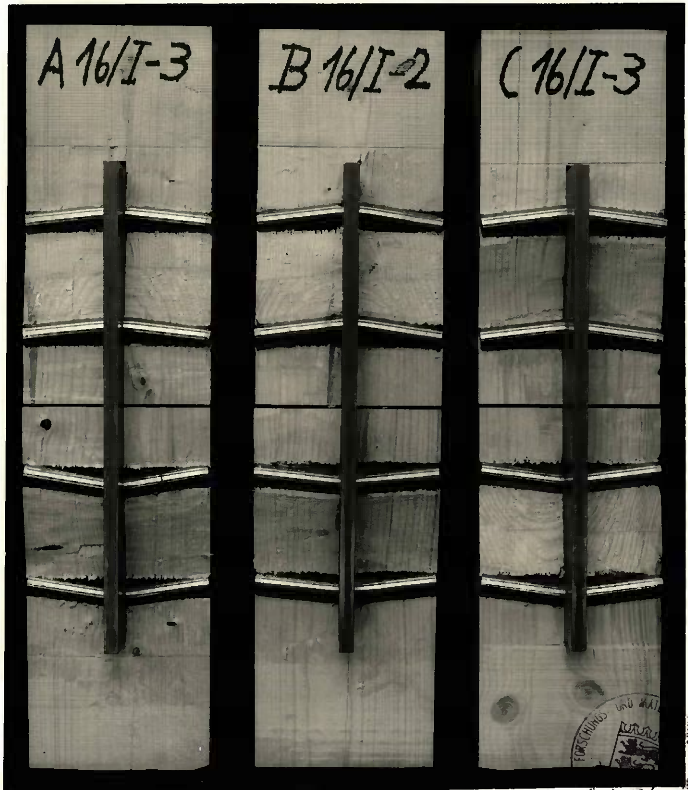
Abb. 13 Probekörper A16/I-3, B16/I-2 und C16/I-3 nach der Prüfung. Zum Fotografieren wurde das Holz in der Ebene von vier Stabdübeln aufgespalten.
