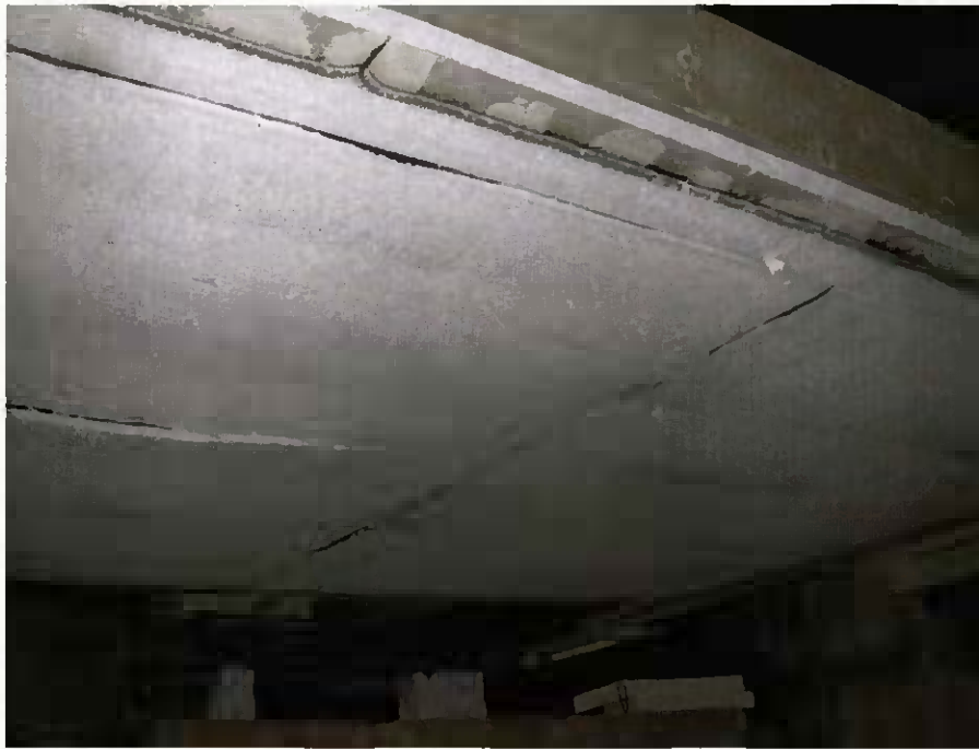
Probekörper nach der Brandprüfung
