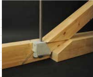
Freigelegter, neuartiger Betonknotenanschluss für Holzfachwerke
