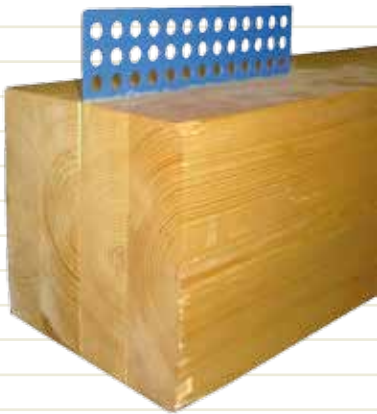
In Brettschichtholz eingeklebtes Lochblech mit dreilöchriger Einbindetiefe
