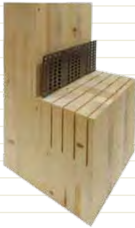
In Brettschichtholz eingeklebtes Lochblech mit dreilöchriger Einbindetiefe
