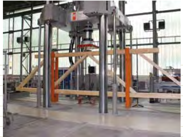
Ausführungsbeispiel: Fachwerkträger-Ausschnitt bei der Traglastprüfung
