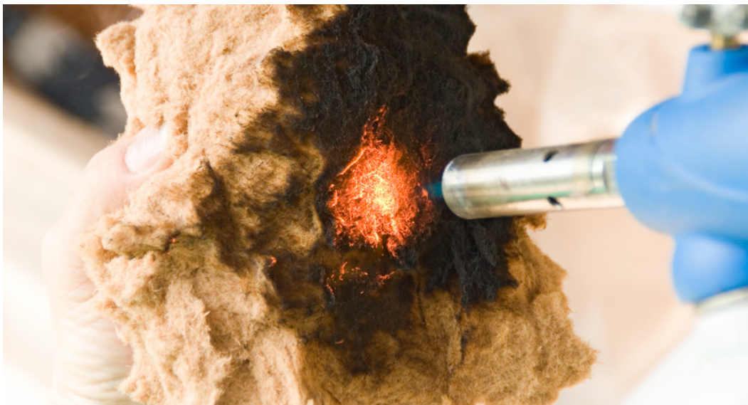
Abb. 10: Holzfaserdämmungen zeigen bei direkter Beflammung kein Schmelzen oder Abtropfen. Die entstehende Verkohlungs-schicht bildet eine wirksame Dämmschicht
