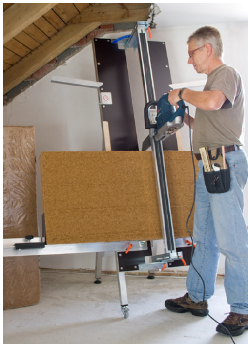
Abb. 28: Mobile Schneidetechnik für den schnellen und exakten Zuschnitt von flexiblen und druckfesten Holzfaserdämmstoffen
