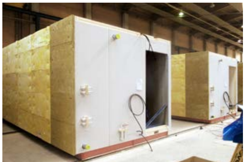
Abb. 29: Holzmodule können den Vorfertigungsgrad erhöhen
